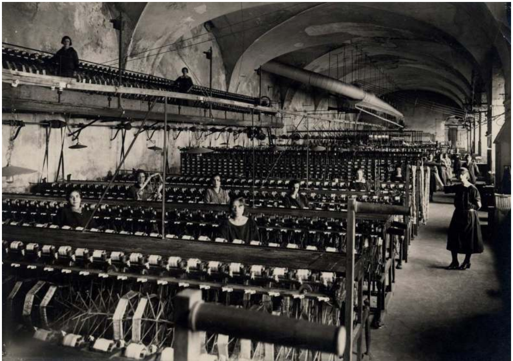
Fig. 107 • L'intérieur d'un moulinage, Flaviac (vallée de l'Ouvèze), vue intérieure. Au premier plan et sur la tribune, les banques à dévider, au second plan les doublages. Archives départementales de l'Ardèche, 07 Fi 090-05. Fonds Pierre Jacquin
