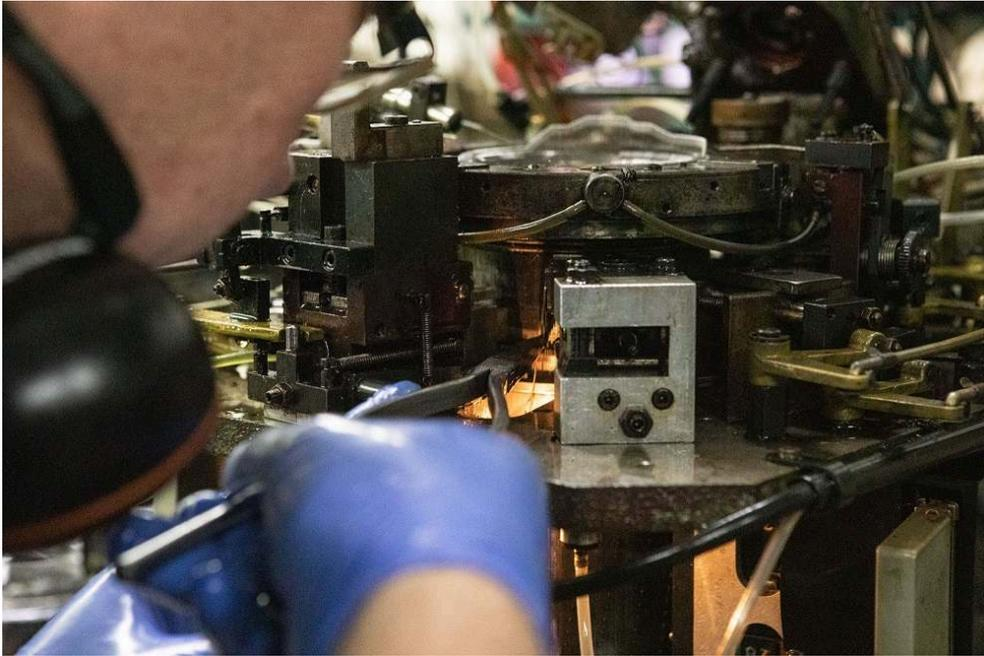
Sumène (Gard), L'Arsoie, insertion d'une aiguille par Jean-Marc Dubois dans le cylindre d'un métier Santi. Cette insertion est effectuée en deux temps.
