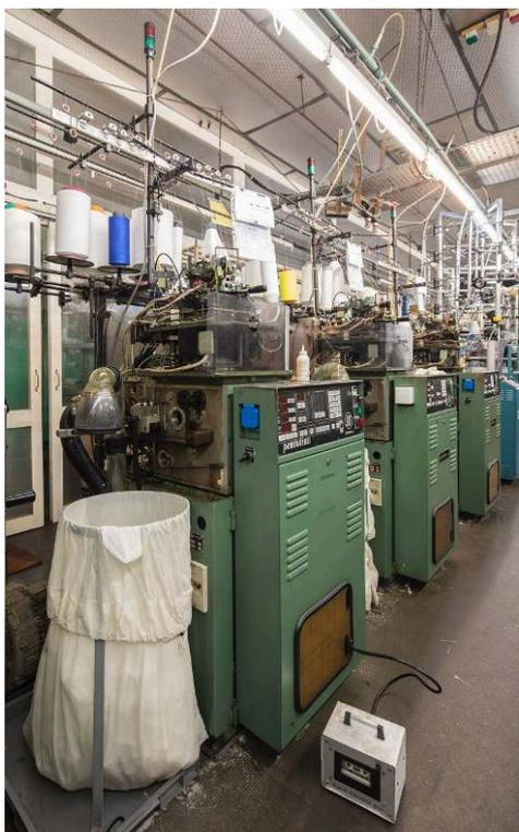
Sumène (Gard), L'Arsoie, métier à tricoter circulaire du constructeur Santoni, type EJ16, datant des années 1980. Ces métiers sont commandés par des programmes encodés sur une cassette à bande magnétique.
