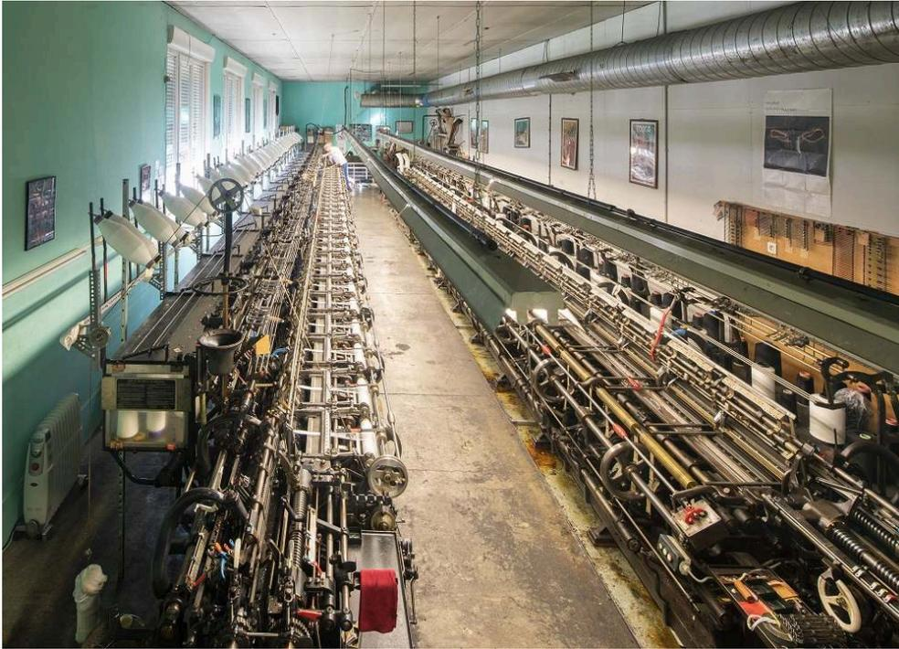
Sumène (Gard), L'Arsoie, métiers à tricoter rectilignes du constructeur *Textile Machine Work*, datant des années 1930. Le métier à 30 sections (jauge 60), à gauche, fait face au métier manuel à 24 sections (jauge 51)
